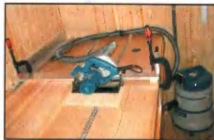
Стартовая позиция пилы перед поперечным резанием
