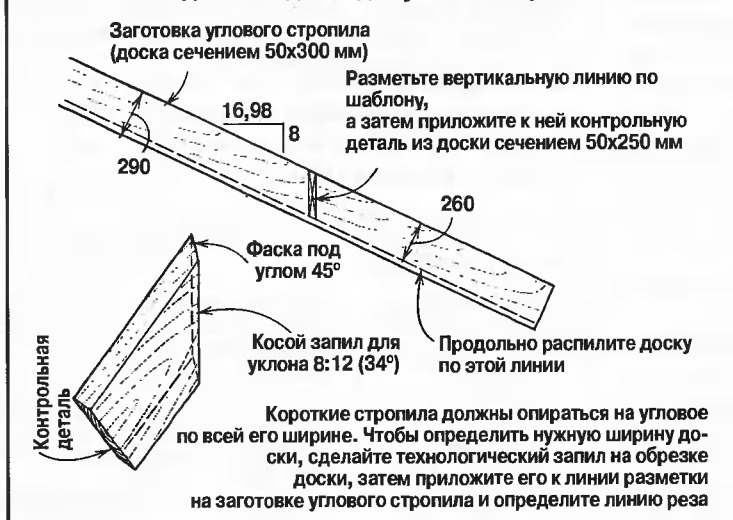
Рис. 4. Подготовка доски для углового стропила
